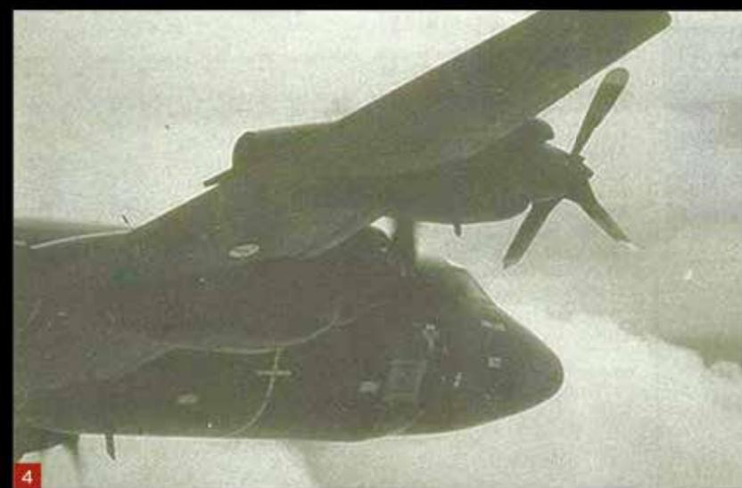
**P-3 «Орион» (Lockheed P-3 Orion)** – береговой патрульный самолет, созданный в 1959 году. В странах НАТО часто используется в качестве самолета-разведчика. Экипаж – 10 человек. Обладает хорошими маневренными характеристиками, поисковая скорость – 300–320 км/ч, максимальная – 760 км/ч, дальность полета – до 9000 км, продолжительность полета – до 17 ч, может быть увеличена при выключении полетный вес, двух двигателей.
