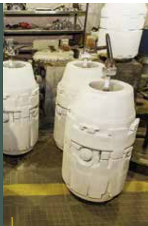
Песчаные стержни, создающие внутреннюю форму модуля ракеты
