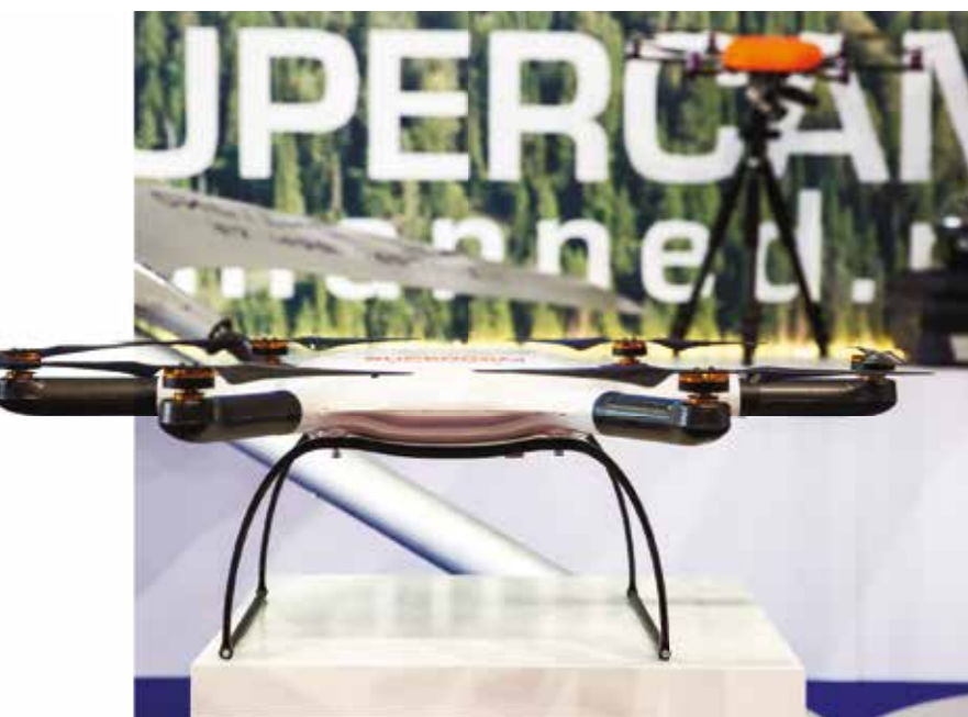
Мультикоптер Supercam X6-M2 компании Unmanned. Его отличительная способность – возможность выхода на точку посадки по анализу изображения, получаемого с видеокамеры
